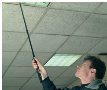
Contrôle de continuité sur plafonnier avec perchette de contact (Réf. M-951143) raccordée au Cathom™ NG.
