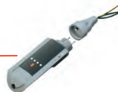
Contrôle des différentiels avec le Catex™ NG DT-170 muni du cordon pour intervention sur tableau (Réf. M-952271).
