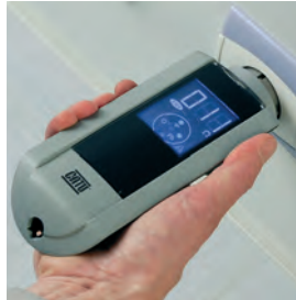
Mesure de la résistance de terre sur prise 2P+T avec le Catohm™ NG (Réf. DT-300).
