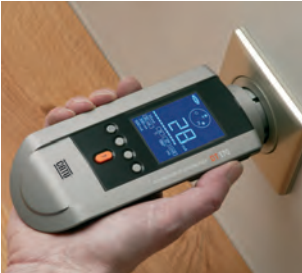
Contrôle de prise 2P+T et de différentiel avec le Catex™ NG (Réf. DT-170).
