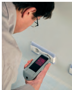
Mesure de la résistance de terre sur prise 2P+T avec le Cathom™ NG (Réf. DT-300).
