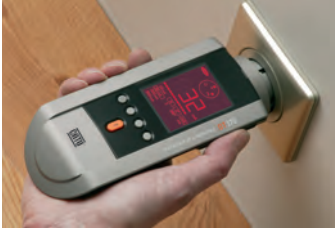
Contrôle de différentiels sur prise 2P+T avec le Catex™ NG (Réf. DT-170).
