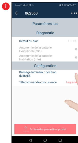
Dans la partie " Configuration " cliquer à droite de " Balisage lumineux : position du BAES " sur le numéro
