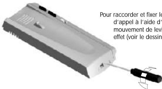
Pour raccorder et fixer le poste d'appel, ouvrir le poste d'appel à l'aide d'un tournevis plat, en exerçant un mouvement de levier dans la rainure prévue à cet effet (voir le dessin ci contre).
