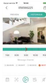
Les zones rouges indiquent une détection d'évènement, les zones vertes indiquent l'enregistrement sur la carte SD sans détection et les zones blanches indiquent l'absence d'enregistrement.
