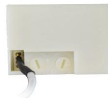
Dévisser les 4 vis du bloc Batterie pour accéder au bloc détecteur.
