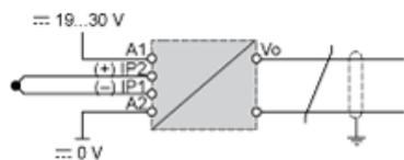
Les lignes d'entrée, de sortie et d'alimentation doivent être séparées des câbles d'alimentation pour éviter les effets d'interférence induite. Les câbles d'entrée et de sortie doivent être blindés comme indiqué dans le schéma et ils doivent être distanciés entre eux.
