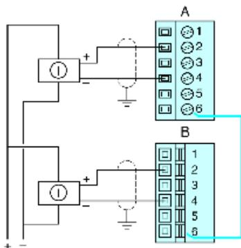
2 capteurs analogiques non isolés, alimentation 24 VCC fournie par le PDM
