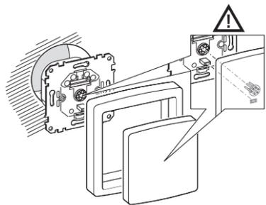
**PRECAUCIÓN Las clavijas de contacto se pueden deformar.** Las clavijas de la parte trasera de la placa sensora se pueden deformar si se doblan. Por ello, conecte siempre la placa sensora de forma recta.
