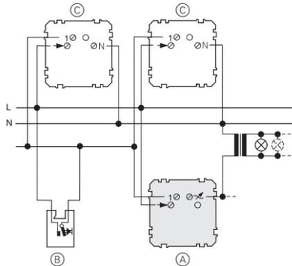
**i** É **necessário** um condutor neutro ao utilizar o módulo adicional de telecomutação.
