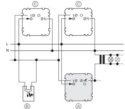
**i** Es **necesario** un conductor neutro para el uso de la unidad de extensión TELE.
