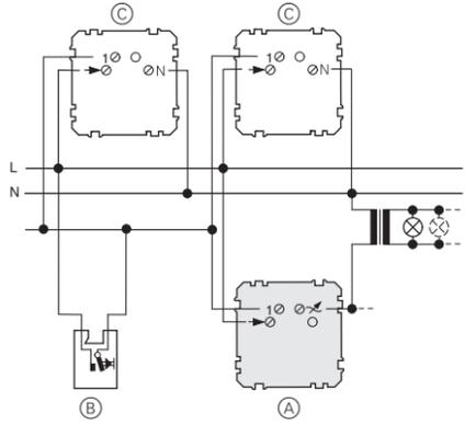
**i** Un conducteur neutre est **requis** en cas d'utilisation d'un mécanisme auxiliaire à télécommande.
