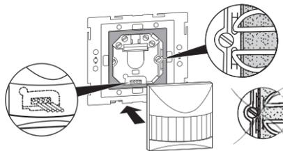
Pode fixar a armação na parede com parafusos adequados.
