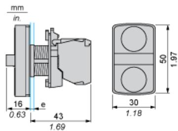
e : épaisseur du dispositif de serrage : 1 à 6 mm / 0,04 à 0,24 pouce
