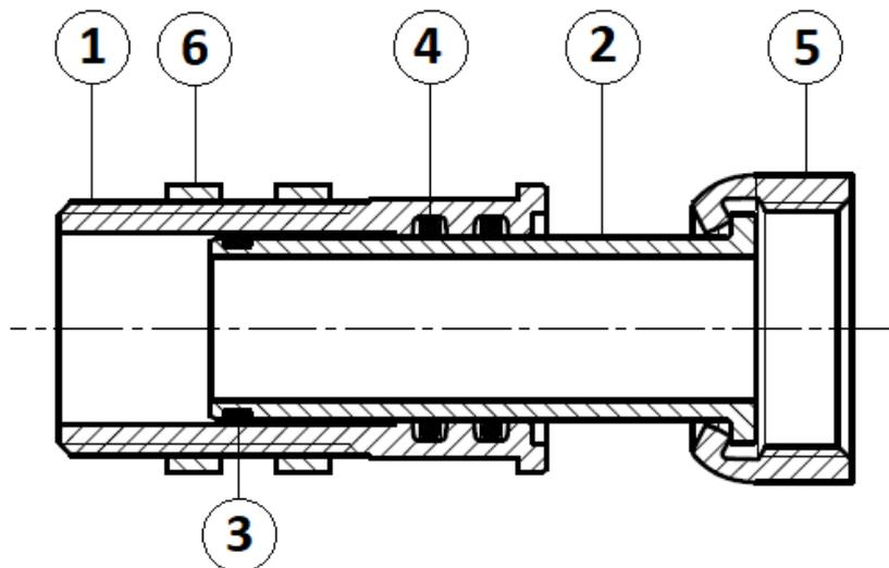
**A partir du DN25, blocage par contre écrou avec joint fibres :**
