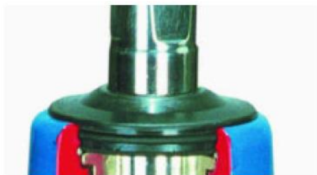
Boite à joints avec sécurité contre le desserrage intempêtif et protection par un joint pare poussière
