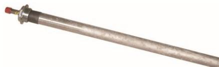
**Avec ce modèle d'anode simple test, le contrôle se fait en dévissant le bouchon rouge. En cas d'écoulement d'eau l'anode est à remplacer**
