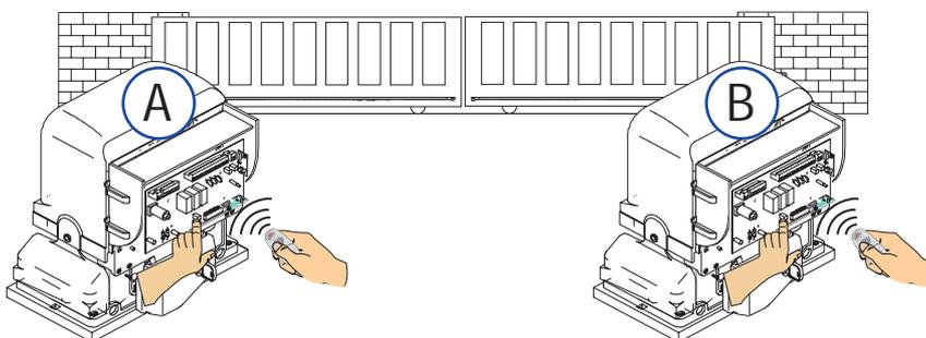
6) Pour le système de déblocage de l'automatisme sur les deux moteurs, placer une carte radio "AF2" sur la carte de commande du moteur "A" et une sur celle du moteur "B" et passer à la procédure de montage du pratico system (voir chapitre 8, page 16) sur les deux cartes.
