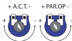
**Trimmer A.C.T.** = Temps de fermeture automatique. Il règle le temps d'attente du portail en position d'ouverture, appelé «temps de pause», une manœuvre de fermeture s'active automatiquement lorsque ce temps s'est écoulé. Le «temps de pause» peut être réglé de 1 à 120 secondes.
