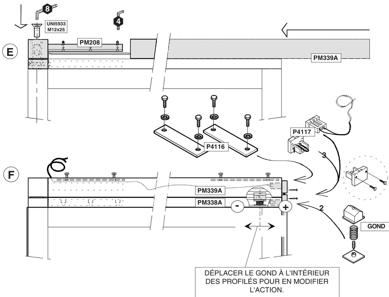
**E-** Fixer la vis d'accouplement M12x25 et bloquer de nouveau la vis de fixation (si nécessaire). Placer le profilé supérieur PM339A sur l'articulation supérieure PM208 et fixer les vis à six pans fournies de série. Aligner correctement au profilé avant de bloquer.
