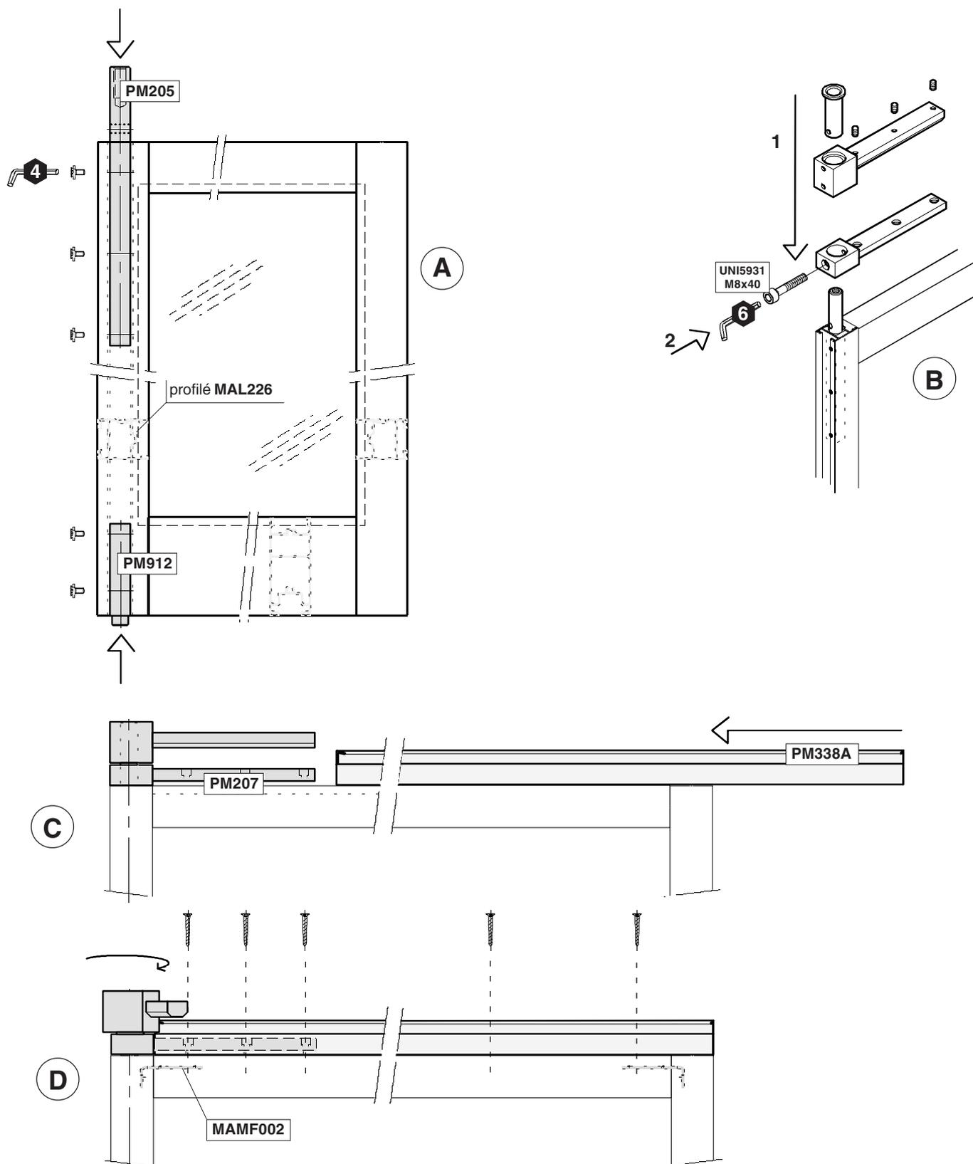
**A-** Placer les axes supérieur PM205 et inférieur PM912 dans le profilé du montant arrière MAL226 et les fixer dans les trous correspondants à l'aide des vis fournies de série. Les aligner correctement au profilé avant de les bloquer.
