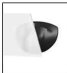
Ne pas placer le détecteur directement derrière un panneau ou un matériau quelconque.
