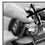
Eviter tout contact avec les parties électroniques (décharges électrostatiques).
