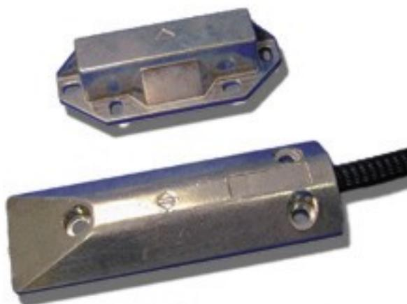
Particolarmente adatto per l'installazione su serramenti in ferro. Cavo di uscita 4 conduttori, per contatto ed antimanomissione, protetto da guaina in acciaio e gomma. Distanza di funzionamento 35 mm in aria libera. Contenitore in alluminio pressofuso.
