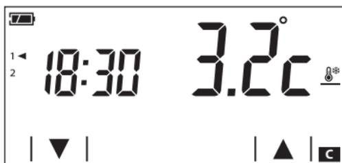
Lorsque l'installation opère en mode antigel (⊖\*) les flèches permettent de régler la température ambiante minimum tolérée ; la température lue réapparaîtra ensuite.
