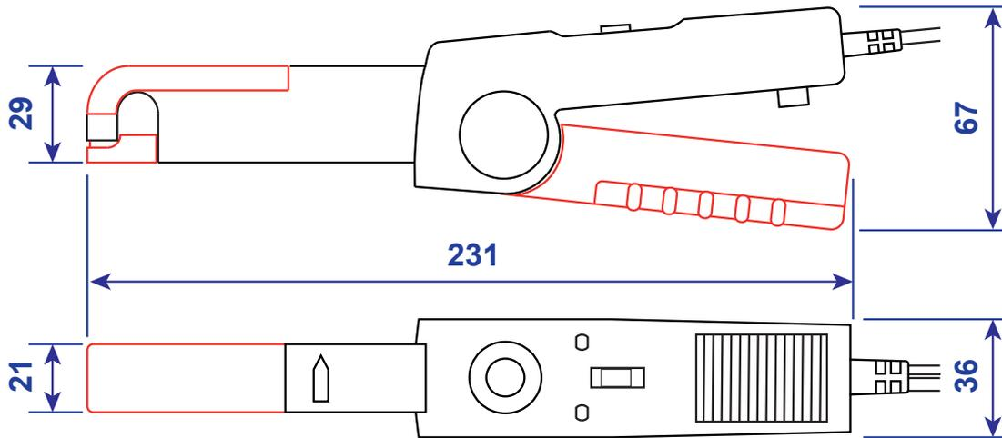
Capacité d'enserrage : 11,8 mm de diamètre
