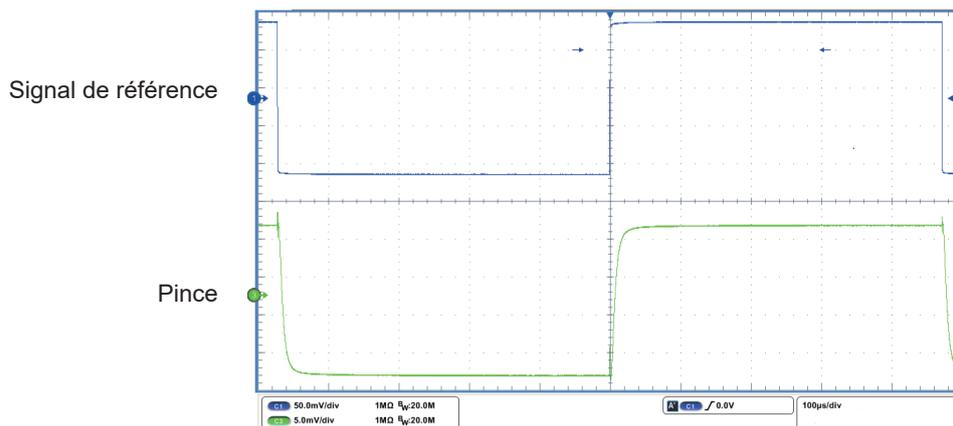
Réponse impulsionnelle à  $\pm 0,5$  Acrête à la fréquence de 1 kHz sur le calibre 1 V/A
