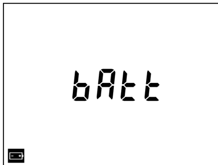
Figure 5 : L'indication de batterie faible nécessitant un remplacement.
