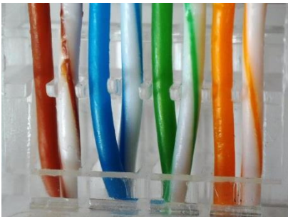
Des pions de centrage permettent de séparer et guider les fils
