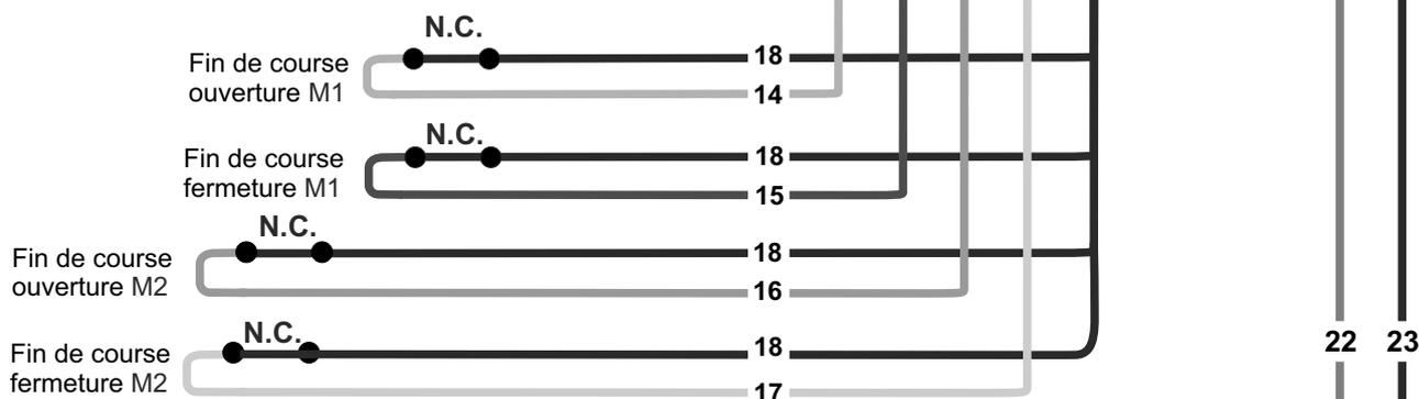
**⚠** Pour le fonctionnement correct des fins de course, il faut que le vers de mouvement des moteurs et les respectifs fins de course engagés correspondent
