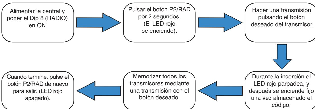
① La salida ocurre automáticamente 10 segundos después de la última transmisión.
