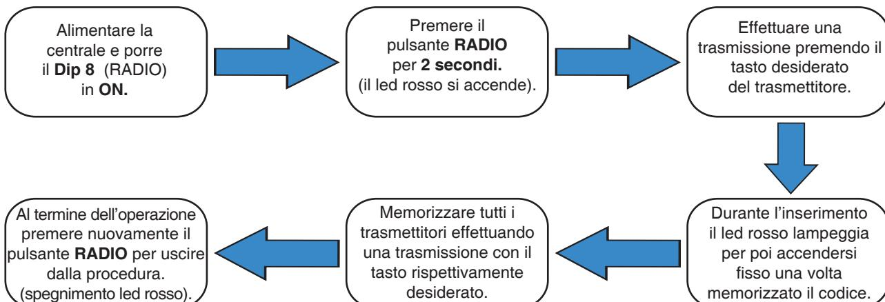
① L'uscita dalla procedura avviene comunque in modo automatico dopo 10 secondi dall'ultima trasmissione.
