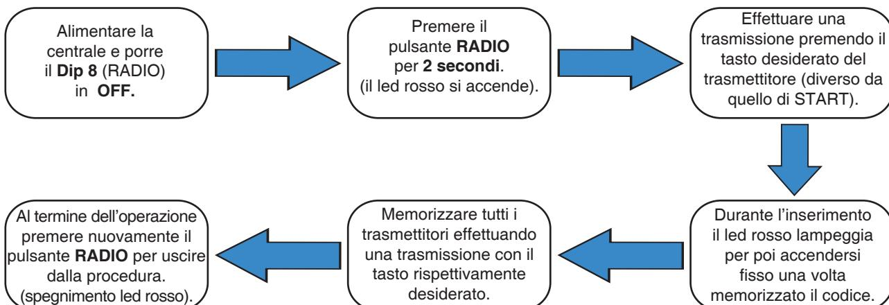
① Un eventuale pressione del tasto già programmato per l'attivazione dell'automazione (**START**) sostituisce l'utilizzo del canale.
