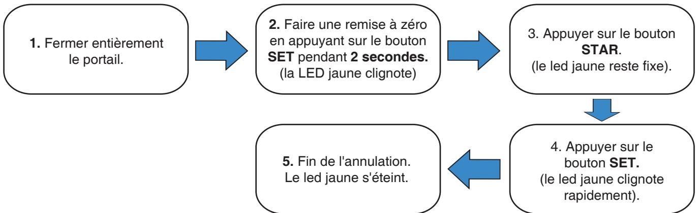
Après l'annulation il sera possible d'activer l'ouverture piéton seulement par fils et l'ouverture du moteur MOT1 sera totale (bornes 24, 25).
