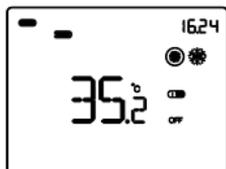
Il **funzionamento protezione alte temperature** è attivo solo in raffrescamento, a impianto di termoregolazione spento (OFF).
