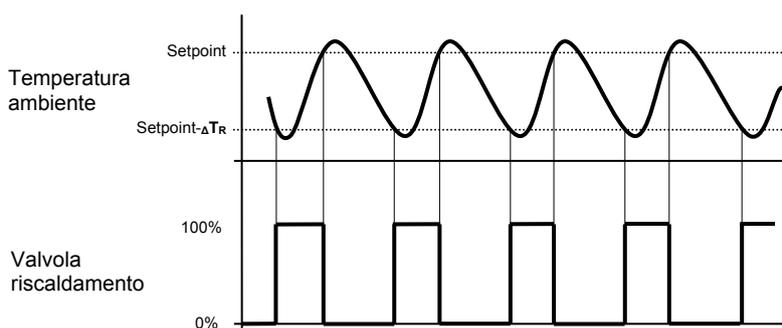
Quando la temperatura misurata è inferiore al valore "setpoint- $\Delta TR$ " (dove  $\Delta TR$  identifica il valore del differenziale di regolazione del riscaldamento) il dispositivo attiva l'impianto di riscaldamento inviando il relativo comando percentuale bus all'attuatore che lo gestisce; quando la temperatura misurata raggiunge il valore del setpoint impostato, il dispositivo disattiva l'impianto di riscaldamento inviando il relativo comando percentuale bus all'attuatore che lo gestisce.
