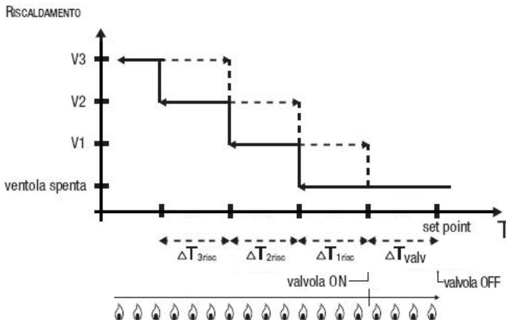
La figura si riferisce al controllo delle velocità del fancoil con tre stadi di funzionamento per quanto riguarda il riscaldamento. Osservando il grafico, si nota come per ogni stadio esista un ciclo di isteresi, nonché ad ogni velocità sono associate due soglie che ne determinano l'attivazione e la disattivazione. Le soglie vengono determinate dai valori impostati ai vari differenziali di regolazione, e si possono così riassumere:
