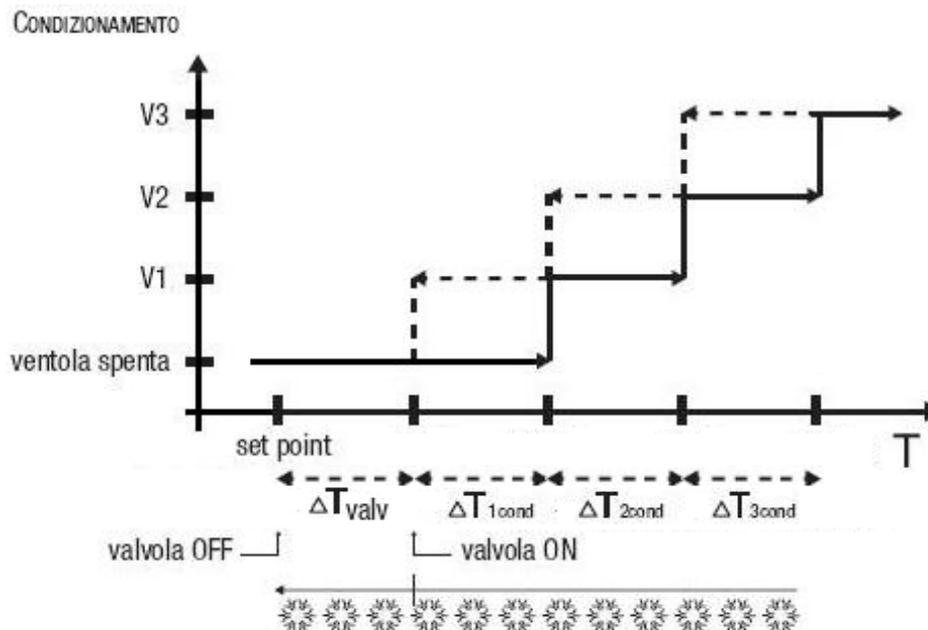
La figura si riferisce al controllo delle velocità del fancoil con tre stadi di funzionamento per quanto riguarda il condizionamento. Osservando il grafico, si nota come per ogni stadio esista un ciclo di isteresi, nonché ad ogni velocità sono associate due soglie che ne determinano l'attivazione e la disattivazione. Le soglie vengono determinate dai valori impostati ai vari differenziali di regolazione, e si possono così riassumere:
