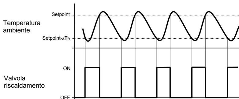
Quando la temperatura misurata è inferiore al valore “setpoint- $\Delta TR$ ” (dove  $\Delta TR$  identifica il valore del differenziale di regolazione del riscaldamento) il dispositivo attiva l’impianto di riscaldamento inviando il relativo comando bus all’attuatore che lo gestisce; quando la temperatura misurata raggiunge il valore del
