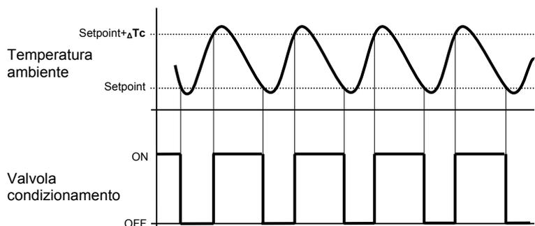
Quando la temperatura misurata è superiore al valore "setpoint+ $\Delta Tc$ " (dove  $\Delta Tc$  identifica il valore del differenziale di regolazione del condizionamento) il dispositivo attiva l'impianto di condizionamento inviando il relativo comando bus all'attuatore che lo gestisce; quando la temperatura misurata raggiunge il valore del setpoint impostato, il dispositivo disattiva l'impianto di condizionamento inviando il relativo comando bus all'attuatore che lo gestisce.
