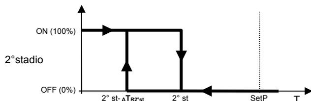
Quando la temperatura misurata è inferiore al valore " $2^\circ \text{ st} - \Delta T_{R2^\circ \text{ st}}$ " (dove  $\Delta T_{R2^\circ \text{ st}}$  identifica il valore del differenziale di regolazione del 2° stadio riscaldamento) il dispositivo attiva il 2° stadio di riscaldamento
