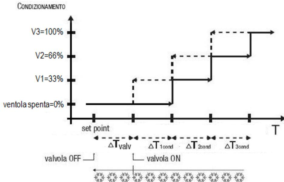
La figura si riferisce al controllo delle velocità del fancoil con tre stadi di funzionamento per quanto riguarda il condizionamento. Osservando il grafico, si nota come per ogni stadio esista un ciclo di isteresi, nonché ad ogni velocità sono associate due soglie che ne determinano l'invio del valore associato. Le soglie vengono determinate dai valori impostati ai vari differenziali di regolazione, e si possono così riassumere:
