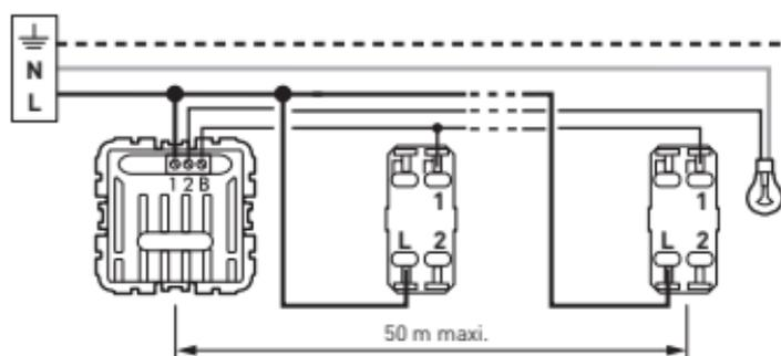
Fonction télérupteur comprise, à ne pas utiliser avec un télérupteur au tableau électrique.
