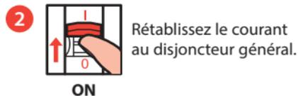
**Il est impératif d'alimenter simultanément l'ensemble des produits câblés.**
