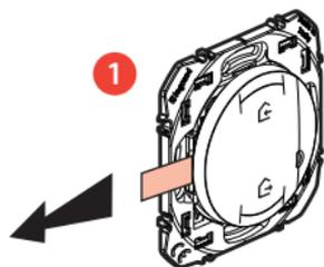
Retirez la languette de protection de la pile pour alimenter la **commande générale sans fil**.
