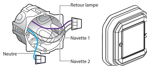
Utilisez un **connecteur** pour raccorder ensemble les 3 fils (retour de lampes, navettes 1 et 2). Utiliser un connecteur séparé pour isoler le fil de neutre.
