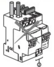
L'interrupteur différentiel doit être protégé en amont, soit par un disjoncteur de branchement Tarif bleu (ex. BACO), soit par un disjoncteur Legrand (ou un fusible gG) de même courant que l'interrupteur différentiel.
