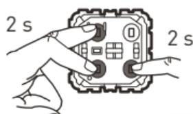
Permet un réallumage systématique au niveau d'éclairage avant la dernière extinction (retour en mode usine)
