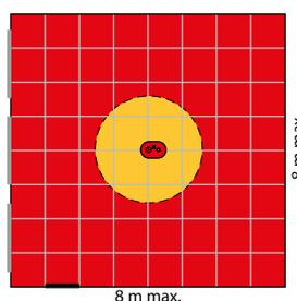
Possibilité de surveiller jusqu'à 6 **Zones d'intérêt** et/ou **d'exclusion** paramétrables.
