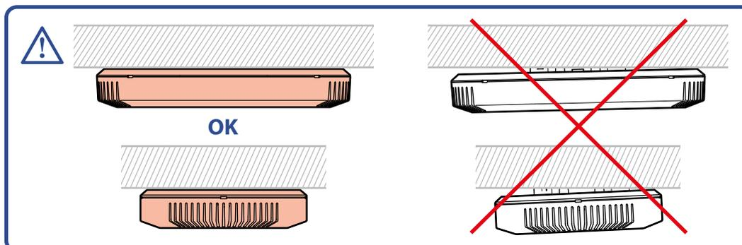
Orientation du capteur parallèle à un mur : il est conseillé d'orienter le détecteur dans le sens de déplacement de la porte vers le fond du local.
