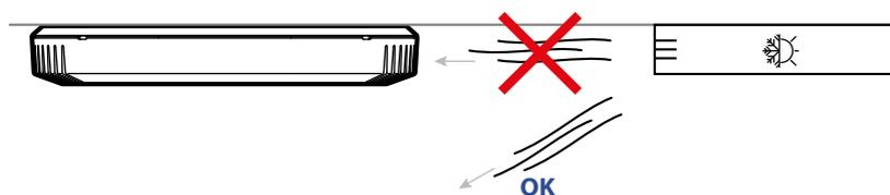
Le capteur ne doit pas être déplacé après sa calibration.
