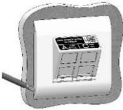
Glisser un tournevis dans les encoches sur les cotés de la plaque de finition.
