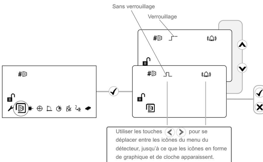
Pour désactiver une alarme incendie verrouillée, appliquer une tension de 5 à 40 V à la borne de réinitialisation externe, entrer le mot de passe ou couper l'alimentation pendant 20 s.
