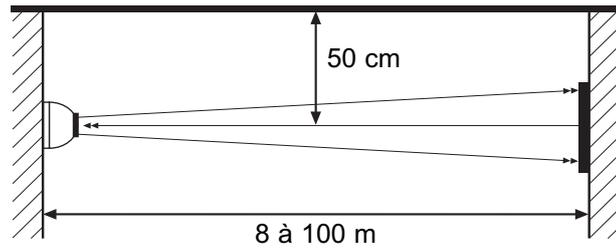
La ligne de visée entre le détecteur et le réflecteur doit être dégagée.
