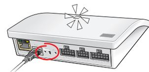
Appuyer brièvement (1 seconde) sur le ⏻ bouton situé à l'arrière de l'interface avec un objet pointu. La diode clignote en blanc.
