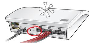
Brancher le faisceau de fils fournis à la borne d'entrée. Appuyer brièvement (1 seconde) sur le bouton RESET situé à l'arrière de l'interface avec un objet pointu. La diode clignote rapidement en blanc. L'étape 15 doit être effectuée dans les deux minutes.
