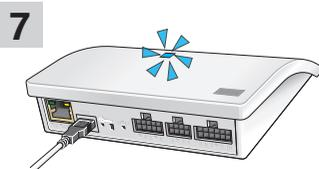
Quand la diode est en bleu l'interface est configurée en mode répéteur.
