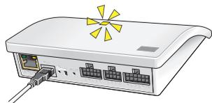
Brancher l'interface au réseau électrique. Lorsque la diode clignote en jaune, l'interface est prête pour la configuration.
