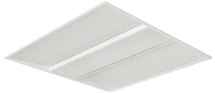
Luminaire LED encastré architectural avec optique micro-prismatique et distribution semi-directe de la lumière. UGR<19. Version haut flux (HO) : 131lm/W. Flux lumineux : 4400lm. Température de couleur blanc neutre (4000K). IRC80. Caisson fermé ( finition blanc RAL 9016) réduisant la pénétration de la poussière et améliorant le facteur de maintenance du luminaire (LMF). IP20, IK03. Dimensions : 595mm x 595mm x 92mm. Durée de vie 100 000 heures (L80). Garantie 5 ans
