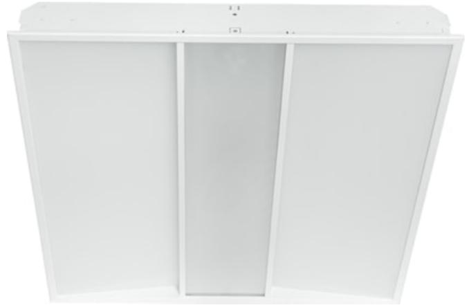
Luminaire LED encastré architectural avec optique micro-prismatique et distribution semi-directe de la lumière. UGR<19. Version haut flux (HO) : 125lm/W. Flux lumineux : 4200lm. Température de couleur blanc neutre (4000K). IRC90. Caisson fermé ( finition blanc RAL 9016) réduisant la pénétration de la poussière et améliorant le facteur de maintenance du luminaire (LMF). IP20, IK03. Dimensions : 595mm x 595mm x 92mm. Durée de vie 100 000 heures (L80). Garantie 5 ans
