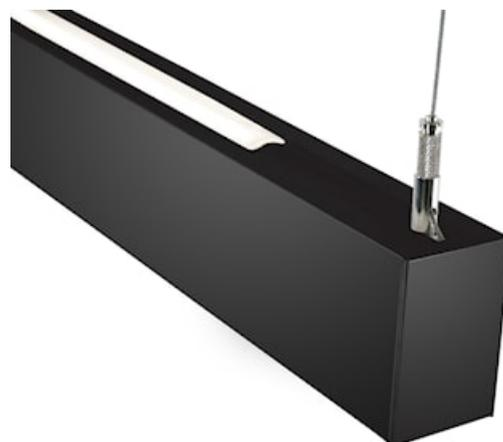
Luminaire LED linéaire, pour installation suspendue. Kit pré-câblé et pré-équipé avec embouts et câbles de suspension. Longueur 2400mm. Finition noire. Diffuseur prismatique. Eclairage direct/indirect (65/35%) adressable séparément via DALI. Flux 7500lm, efficacité lumineuse 129lm/W. Température de couleur : blanc chaud (3000K). IRC > 80 / SDCM < 3. Groupe de risque photobiologique GR0. IP20 / IK03. Durée de vie 92 500 heures (L80). Garantie 5 ans.
