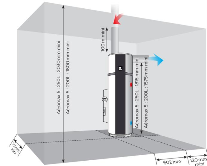
Exemple d'installation gainage extérieur/extérieur
