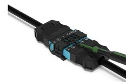
Pour déconnecter le connecteur mâle ou femelle, insérer l'outil de manipulation 210-720 sous la languette à un angle d'environ 15° par rapport au connecteur mâle de 5 mm, puis retirer le connecteur mâle.
