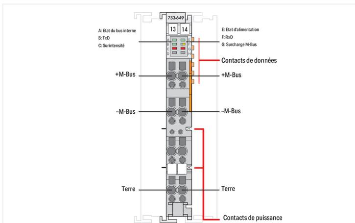
La borne M-Bus (753-649) sert de maître M-Bus et permet la connexion directe des esclaves M-Bus au système WAGO-I/O-SYSTEM 750. Un M-Bus (Meter-Bus) est un bus de terrain permettant la transmission des données de consommation d'énergie collectées par les esclaves M-Bus tels que des compteurs de chaleur, des compteurs d'eau, des compteurs électriques et des compteurs de gaz ainsi que des capteurs et des actionneurs de tout type.
