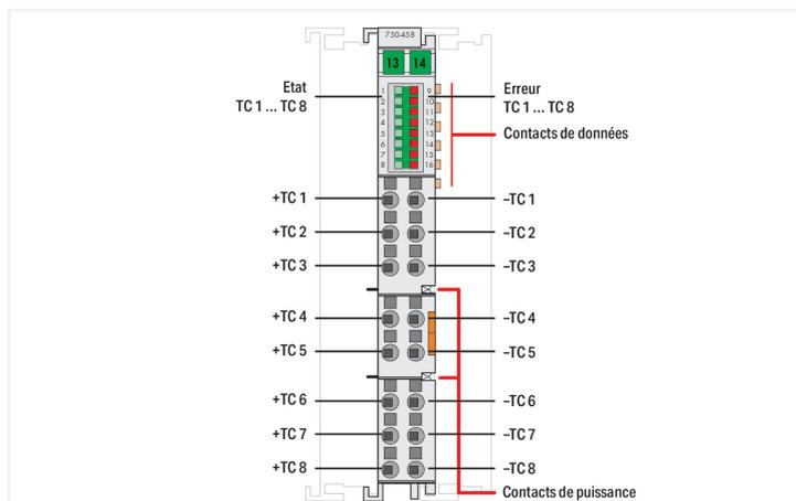
La borne d'entrées permet la connexion directe de thermocouples.
