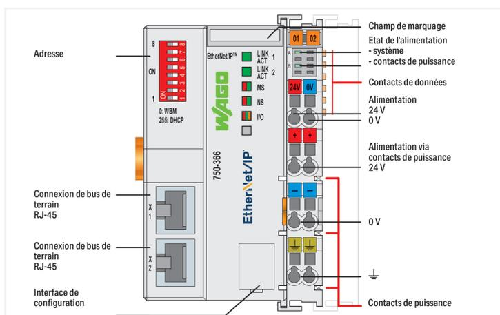
Le coupleur de bus de terrain EtherNet/IP™ 750-366 relie le système modulaire WAGO I/O System avec le réseau EtherNet/IP™.
