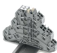
Le contact de pontage vertical pour la gamme de bornes sur rail TOPJOB®S relie deux ou trois niveaux entre eux en bornes à deux/trois étages. Puisqu'il s'agit d'un contact de pontage vertical à deux étages (2002-492) ou d'un contact de pontage vertical à trois étages (2002-493), un repérage visible « 2 » et « 3 » signale le nombre d'étages pontés.
