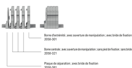
Exemple de barrette à bornes à 4 pôles; avec ouverture de manipulation; avec brides de fixation
