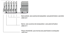
Exemple de barrette à bornes à 5 pôles; avec ouverture de manipulation; avec pieds de fixation à encliqueter
