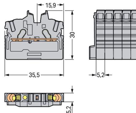
Borne de passage série 2052 avec Push-in CAGE CLAMP®
