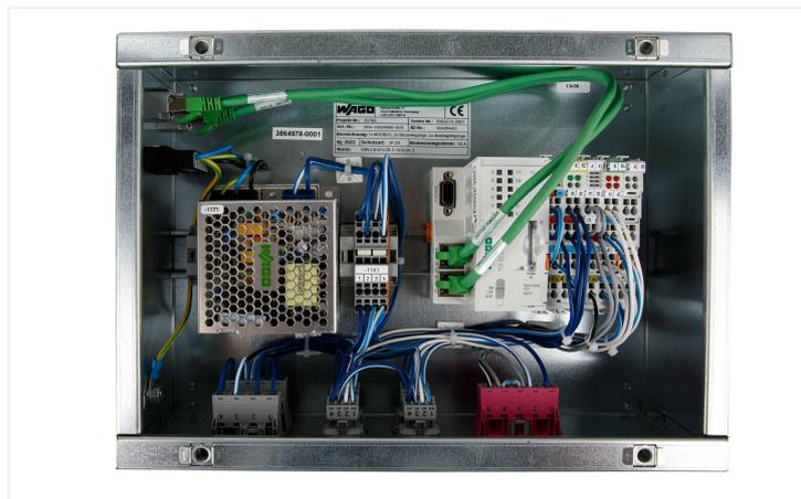
Boîtier de distribution pour l'enregistrement et l'évaluation des capteurs météorologiques
