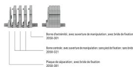
Exemple de bornettes à 5 pôles; avec ouverture de manipulation; avec pieds de fixation à encliqueter
