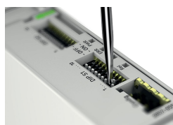
Configuration via micro-interrupteurs
