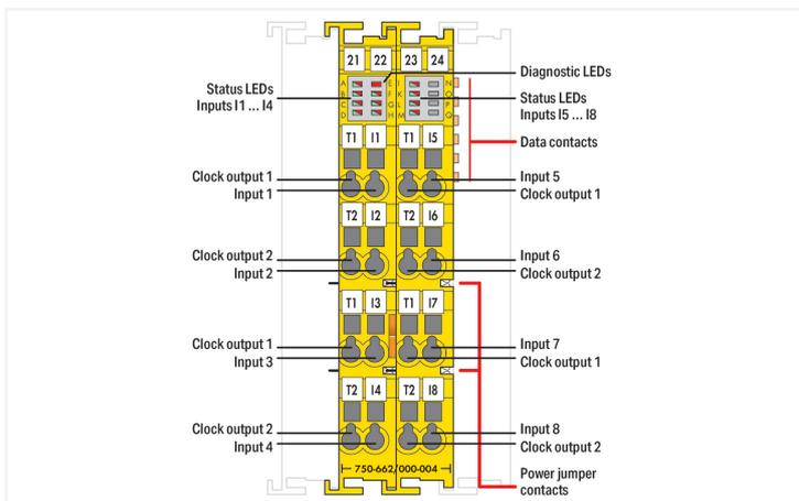
Il est possible de connecter avec la borne PROFIsafe, réf. 75x-662/000-004, des boutons d'arrêt d'urgence libres de potentiel, des interrupteurs de portes de protection, des commutateurs de mode, des capteurs de sécurité ainsi que des sorties à semi-conducteurs de sécurité.
