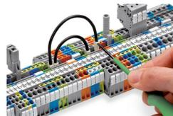
Pousser les conducteurs de pontage jusqu'en butée. Pour un changement du câblage, démonter le conducteur de pontage à l'aide de l'outil de manipulation.
